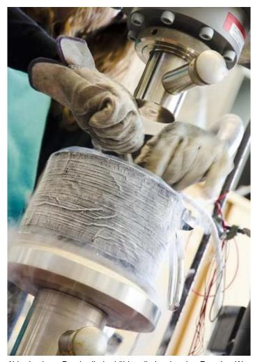
Abb.: In einem Druckzylinder kühlen die Innsbrucker Forscher Wasser auf sehr tiefe Temperaturen ab. (Bild: E. Fessler/U. Innsbruck)
