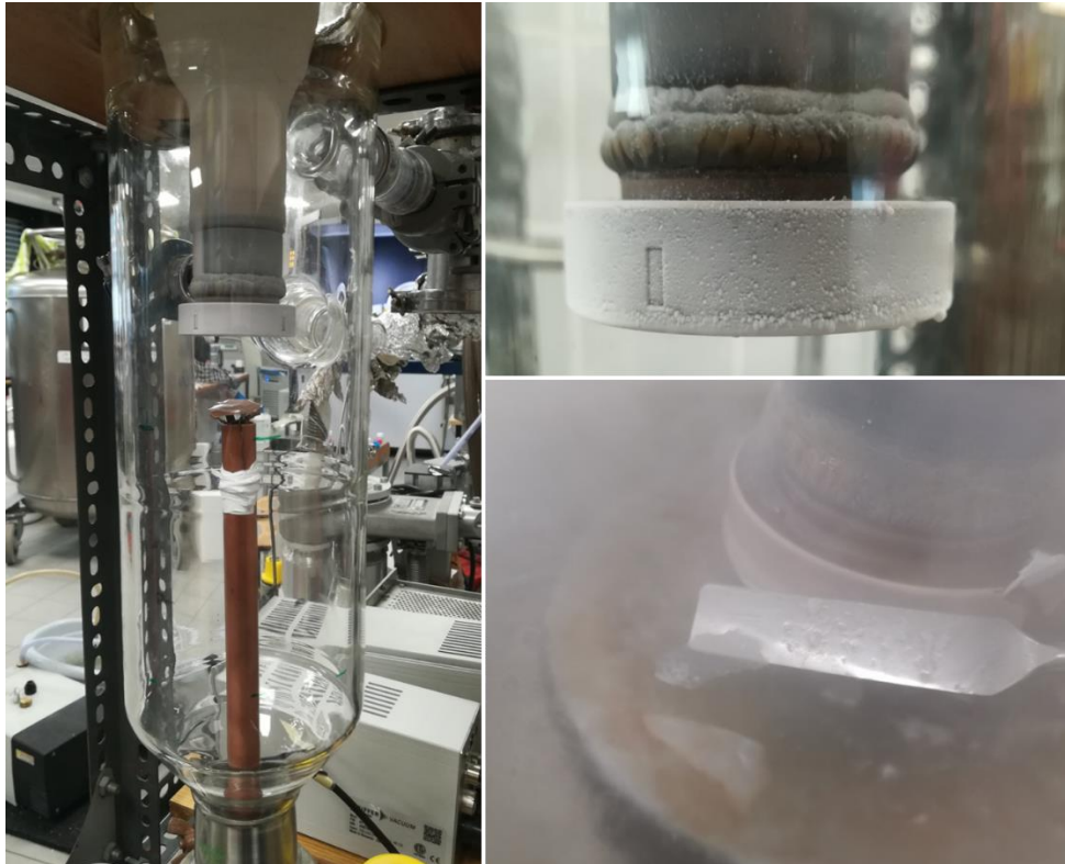
Abbildung 3: Abscheidungsapparatur zur Herstellung von amorphem Eis ASW, sowie Sicht auf die durchsichtige abgeschiedene Probe.
