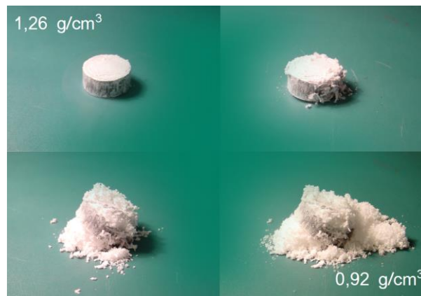
Abbildung 4: Popcorn-Effekt bei der Umwandlung von sehr hoch dichtem (VHDA) zu niedrig dichtem amorphem Eis (LDA), welches zunächst von einem metallischen Ring umschlossen ist
